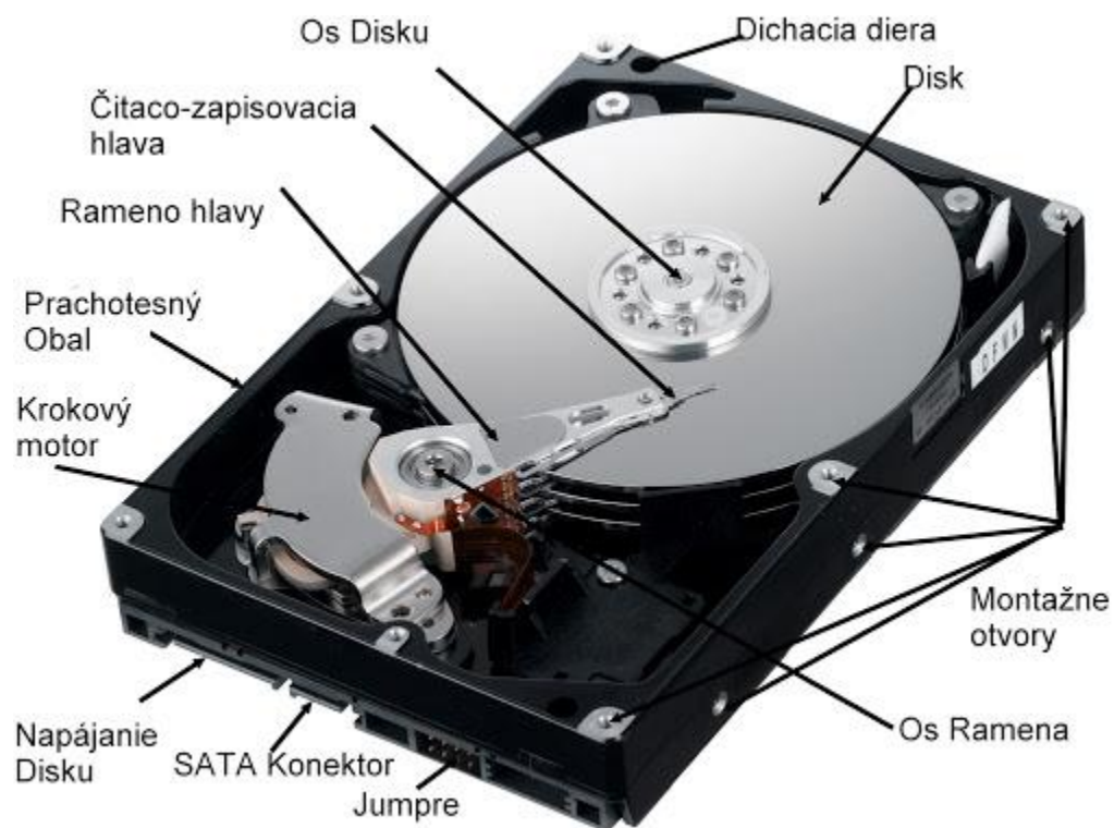
Obrázok 1 Vnútorná štruktúra HDD
