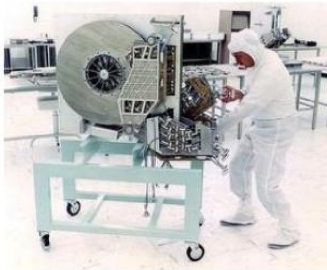
Obr. 6 Pevný disk s kapacitou 512 kB z roku 1975
